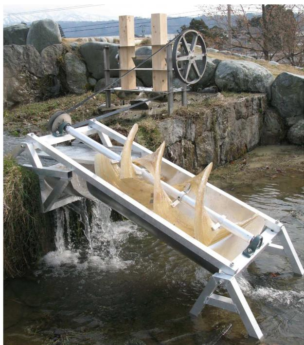
図4 FRP 製羽根らせん水車と杵つき機構
