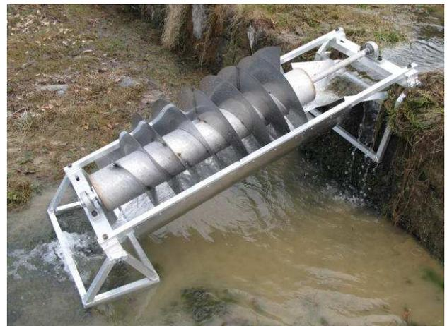
図1 ステンレス製羽根 らせん水車
